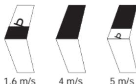
Die Empfindlichkeit der Balkenanzeige entspricht der Grunddämpfung des Varios (
